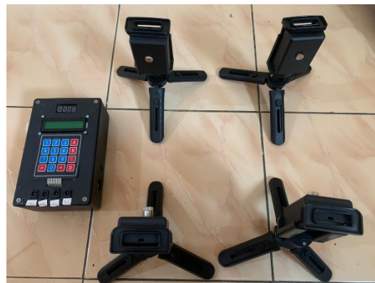
Gambar 3. Semua Komponen Alat ukur Side step test berbasis mikrokontroler
