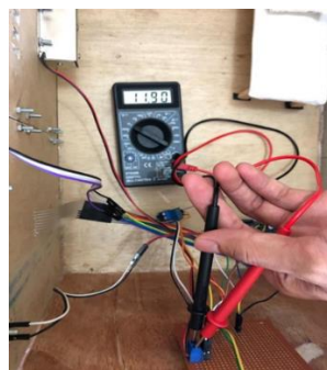
Gambar 14. Hasil Pengukuran Tegangan Selenoid Door Lock Tabel 8. Hasil Pengukuran Tegangan Selenoid Door Lock
